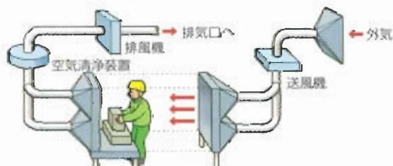
ブッシュブル型換気装置（水平流）の例
