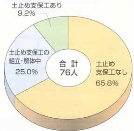
土砂崩壊による死亡災害発生状況 (土止め支保工の状態別)
