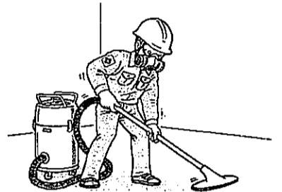
アーク溶接作業における粉じん発生防止対策の例
