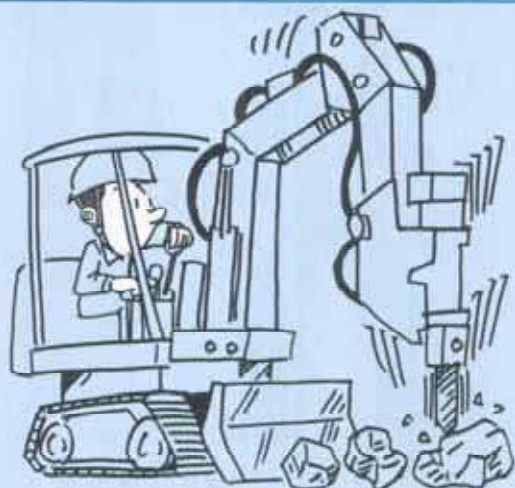
車両系建設機械を用いた掘削作業
