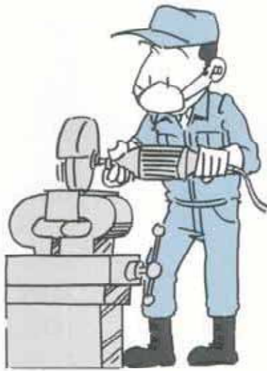
携帯用研削盤での作業
