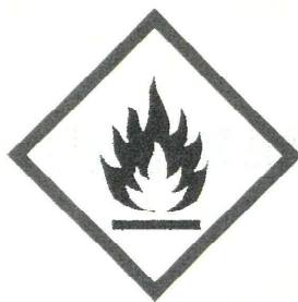
可燃性ガス (区分 1), 自然発火性ガス エアゾール (区分 1, 区分 2), 引火性液体 (区分 1~3), 可燃性固体, 自己反応性化学品 (タイプ B~F) 自然発火性液体・固体, 自己発熱性化学品 水反応可燃性化学品, 有機過酸化物 (タイプ B~F) 純性化爆発物
