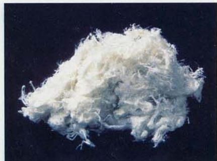
▲白石綿(クリソタイル)
