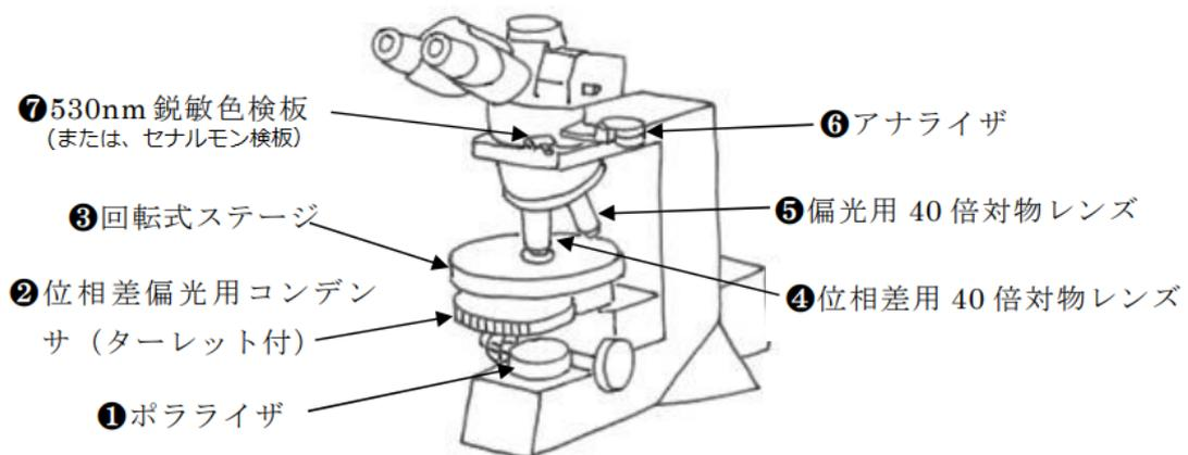
偏光顕微鏡をベースにした位相差／偏光顕微鏡の概略図、位相差/偏光顕微鏡法：
