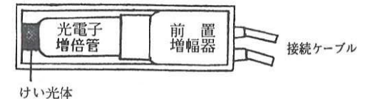
図 1.6 シンチレーションヘッドの構造
